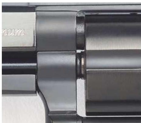
Spalt. Der Trommelspalt ist mit seinem Maß von nur 0,1 mm schon fast zu eng bemessen.
