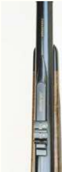
Auf der Büchse im Kaliber .500 Jeffery (12,6x70 Schüler) ist der Visiersockel für das Zweiklappen-Express-Visier aufgelötet. Die Kaliberbezeichnung und die Visierzahlen sind in Gold eingelegt.
