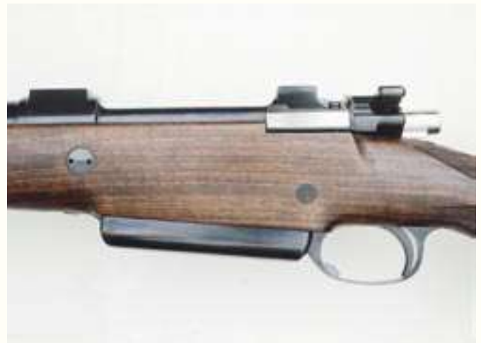
An der Büchse für die .505 Gibbs wurde ein sogenannter Rigby-Deckel installiert. Dadurch wird die Magazinkapazität auf vier Patronen vergrößert. Beide Büchsen haben Flintenabzüge.
