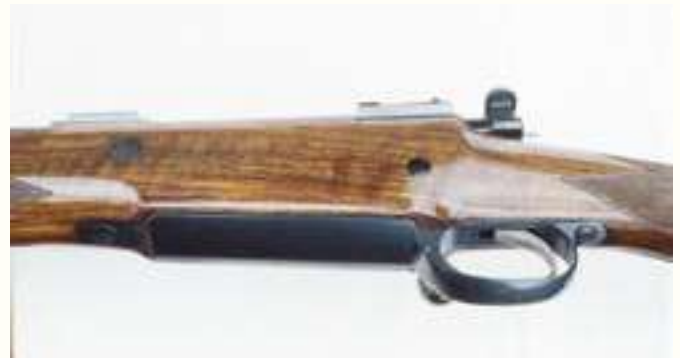
Abzugsbügel mit aufklappbarem Magazindeckel an der .500 Jeffery. In dieser flachen Ausführung fasst das Magazin drei Patronen.
