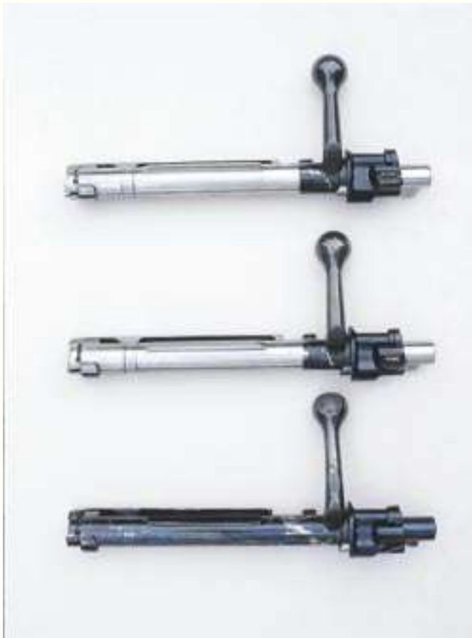
Verschlusskammern für Magnum-Systeme. Unten die Kammer einer originalen Mauser-Magnum-Büchse vor 1937 (Kaliber .280 Halger Magnum). Darüber die beiden neuen Kammern der Johannsen-Büchsen.
